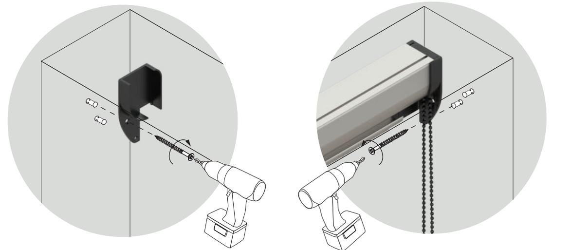
Posiziona le cuffie in plastica nel vano a 5 mm di aria dal soffitto, controlla il parallelismo L 1 e segna la posizione dei fori con un pennarello (Fig 1 e Fig 2). Esegui i fori in entrambi i lati, inserisci i tasselli e fissa la cuffia di sinistra (NB solo quella di sinistra) (Fig 3). Inserisci la cuffia di destra nel cassetto, inserisci il cassetto nell'alloggio all'interno della cuffia di sinistra e sollevalo in posizione dei fori (Fig 4). Fissa la cuffia di destra con le viti (Fig 5).
