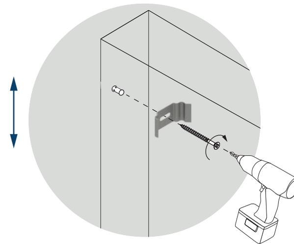
La modalità di installazione con clips laterali permette di installare il cassonetto senza forare il pavimento a terra. Posiziona le clips a parete e assicura il parallelismo L1 (Fig 1 e 2). Segna con un pennarello i fori, esegui i fori e fissa le clips a muro con i tasselli (Fig 2, 3 e 4). Aggancia il cassonetto (Fig 5).
