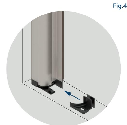
Posiziona la cuffia superiore e quella inferiore nel vano a 5 mm di aria e controlla il parallelismo L 1 (Fig 1 e 5). Segna i punti con un pennarello (Fig 1), esegui i fori, inserisci i tasselli e fissa le cuffie con le viti (Fig 2). Inserisci il cassonetto nelle cuffie (Fig 3) e bloccalo con le due cuffie di chiusura superiore e inferiore (Fig 4).
