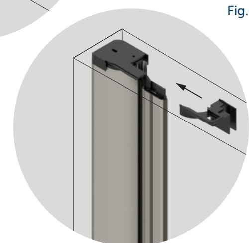
Posiziona la cuffia superiore a 5 mm di aria dalla parete e segna il punto con un pennarello (Fig 1), esegui il foro, inserisci il tassello e fissa la cuffia al soffitto (Fig 2). Inserisci il cassonetto nella cuffia superiore (Fig 3) e controlla il parallelismo L1 (Fig 1 e 4). Segna i punti, esegui i fori e fissa il cassonetto con i tasselli (Fig 5). Completa l'installazione inserendo la chiusura della testata superiore (Fig 6).
