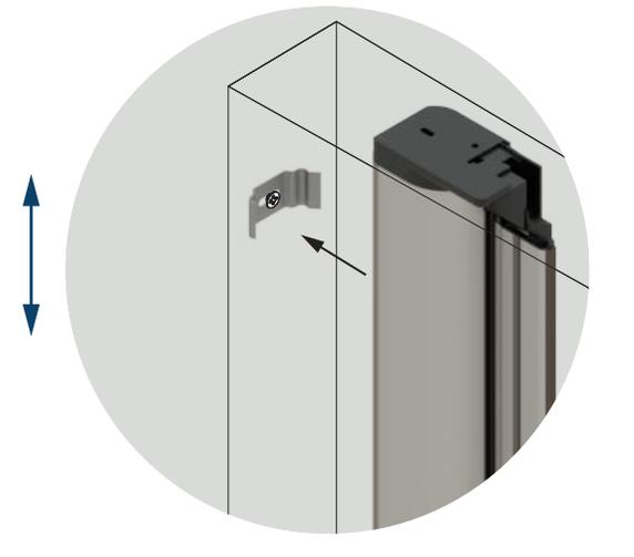
La modalità di installazione con clips laterali permette di installare il cassonetto senza forare il pavimento a terra. Posiziona le clips a parete e assicura il parallelismo L1 (Fig 1 e 2). Segna con un pennarello i punti, esegui i fori e fissa le clips a muro con i tasselli (Fig 2, 3 e 4). Aggancia il cassonetto (Fig 5).
