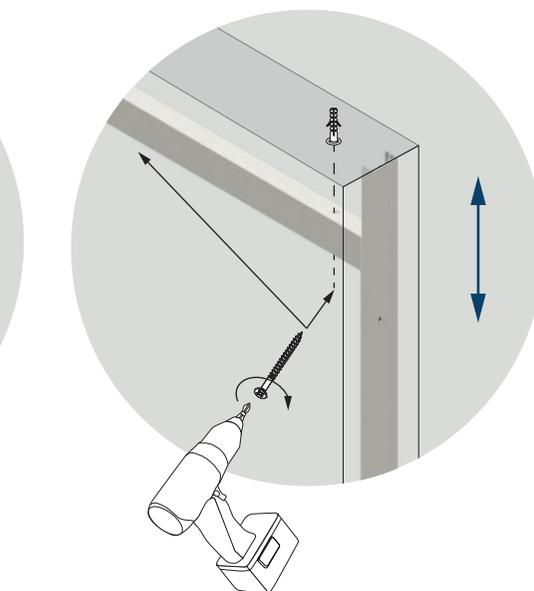
Posiziona il profilo di incontro con calamita in verticale, assicura il parallelismo L1 e segna i punti con un pennarello in corrispondenza dei fori (Fig 1). Esegui i fori (Fig 2), inserisci i tasselli e fissa il profilo con le viti (Fig 3). Inserisci la guida a C nell'alloggio del cassonetto e segna i punti con un pennarello in corrispondenza dei fori (Fig 4), esegui i fori (Fig 5), inserisci i tasselli e fissa il profilo con le viti (Fig 6).
